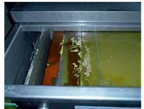
Figuur 2: verwijderen van olie uit ontvettingsvloeistof via een skimmer
