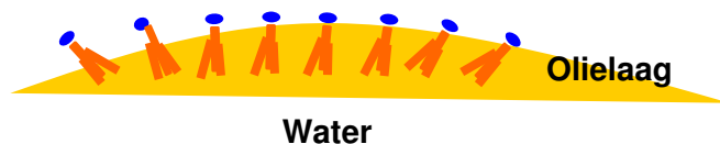
Figuur 2. Schematische voorstelling werking de-emulgerend surfactant
