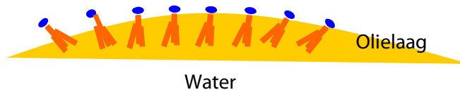
Figuur 2. Schematische voorstelling werking de-emulgerend surfactant
