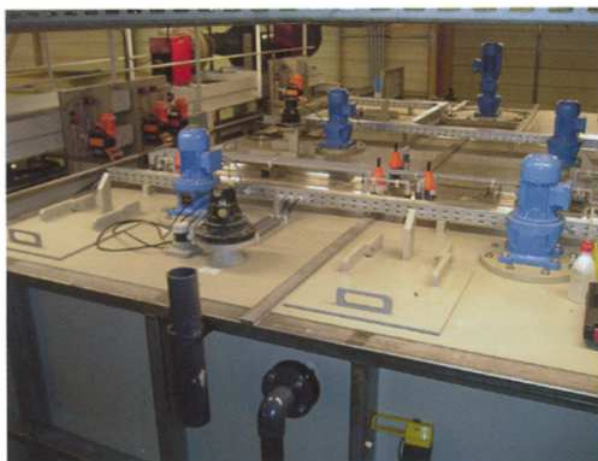
Fysicochemische waterzuivering met geïntegreerde chroomreductie en fluorideverwijdering
